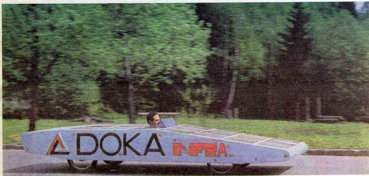
Солнцемобиль «ДОКА-гелио». Масса с аккумуляторами — 170 кг, максимальная скорость — 53 км/ч, площадь фотоэлементов — 6 м 2 , номинальная мощность элементов — 720 Вт, длина — 4500 мм, ширина — 1500 мм, высота — 800 мм.
